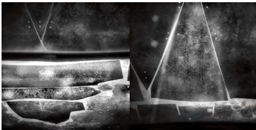
Fig. 15 Radiographie de rayons X d'un vase en métal. La base est ancienne et la panse a été recréée à partir de pièces métalliques triangulaires modernes.
